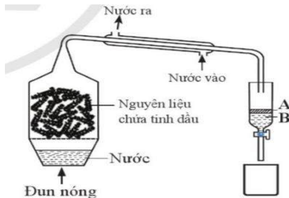
Hình 9.6. Mô hình thiết bị để tách tinh dầu
