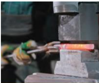
Gia công rèn
